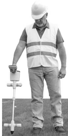
Position des Empfängers für das Verfolgen von Leitungen
