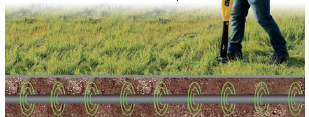
A-Rahmenantenne zur Mantelfehlerortung
