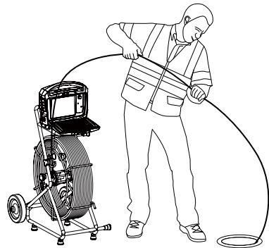
Falsche Platzierung und falsches Schieben können zum Knicken des Schubkabels führen
